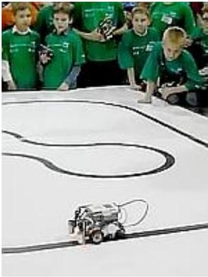
Роботы из лего с программой управления и блоком NXT должны следовать курсу обозначенному черной линией на белом фоне на ровной поверхности. Результаты сравниваются среди достигших финиша роботов по времени.
