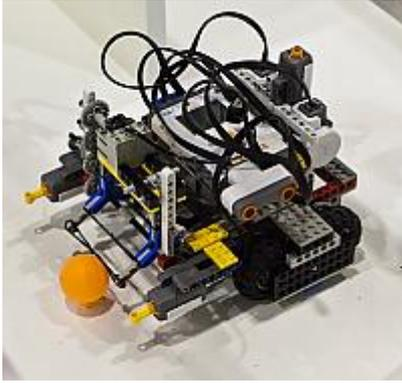
Задача программируемого робота Mindstorms NXT - отправить мяч как можно дальше в сторону цели - метание мяча вдаль. Робот может ударить, подтолкнуть бампером, бросить, доставить мяч до цели любой частью конструкции и любым способом.
